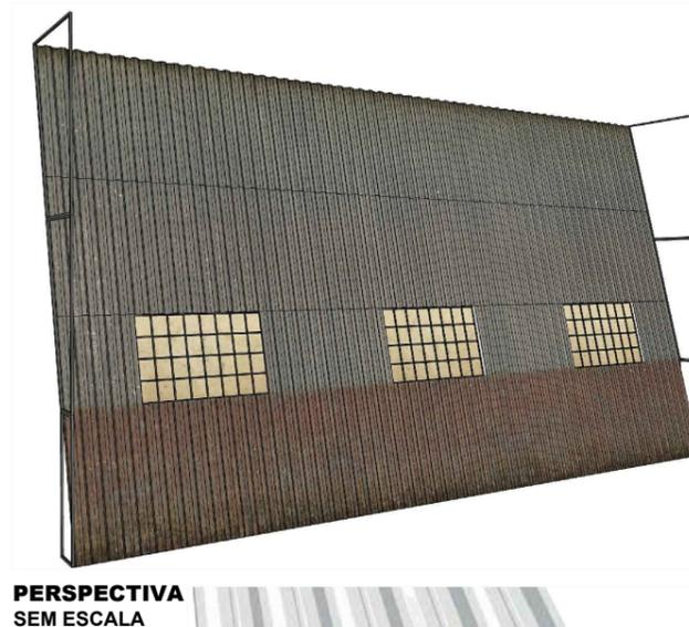
Estrutura em tubos de metalon (especificações indicada em projeto), revestimento de telhas trapezoidal e pintura de arte. Janelas construídas em tubos de metalon (especificações indicadas no projeto) e PS cristal com pintura de arte.
